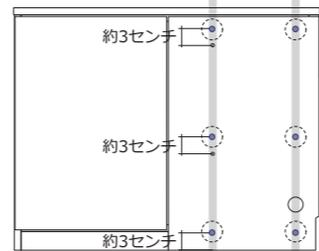
左右連結、配線孔穴を軸に各垂直方向に3ヶ所ずつ、計6ヶ所お貼りください。
